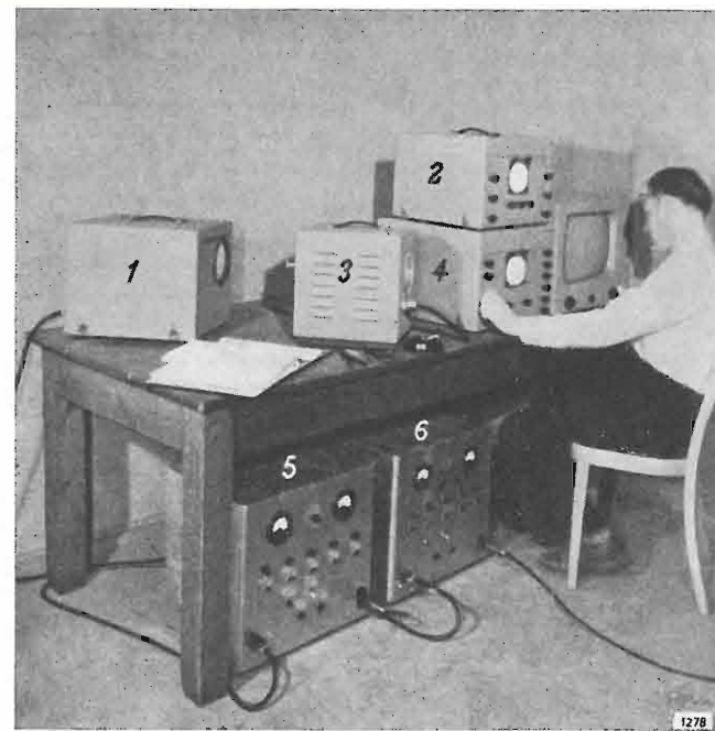
Fig. 7. — I sei elementi portatili che costituiscono il convertitore standard adoperato a Breda: 1 contiene il tubo catodico, l'amplificatore di uscita video e l'oscillatore che fa oscillare lo « spot »; 2 contiene il primo amplificatore video, i generatori di corrente a dente di sega del tubo ricevente e gli organi di comando; 3 è la camera con l'iconoscopio di immagine, tipo 5854, due tubi amplificatori delle correnti a dente di sega di spazzolamento e un preamplificatore del segnale immagine; 4 contiene il secondo amplificatore del segnale immagine, i generatori delle correnti a dente di sega e gli organi di comando; 5 e 6 sono gli apparecchi di alimentazione. All'estrema destra un tubo catodico di controllo.
